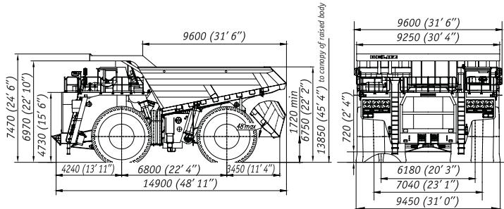
Габаритные размеры указаны для базовой комплектации машин.
