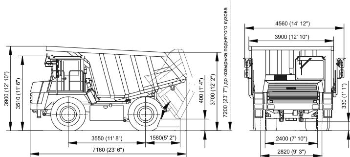
Габаритные размеры указаны для базовой комплектации машин.
